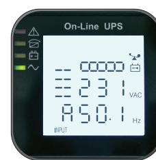
Контрольная панель силового модуля
